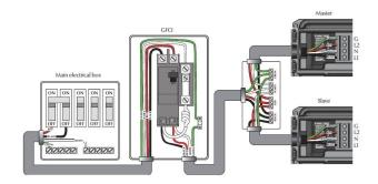
240 VOLT SWIMSPA DUAL GFCI WIRING MASTER / SLAVE HEATER
