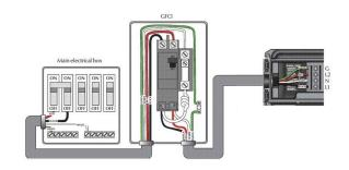
240 VOLT SWIMSPA SINGLE GFCI WIRING MASTER / SLAVE HEATER
