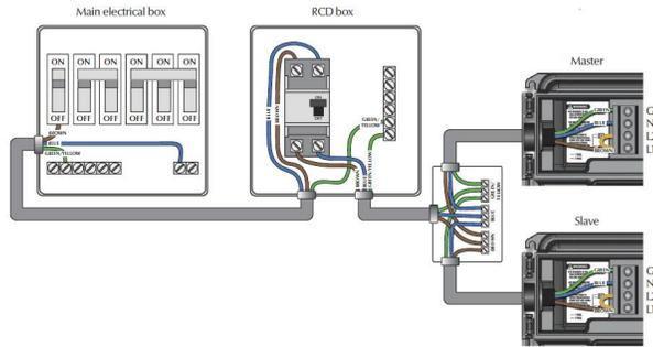
**230 VOLT DUAL PHASE RCD WIRING**
